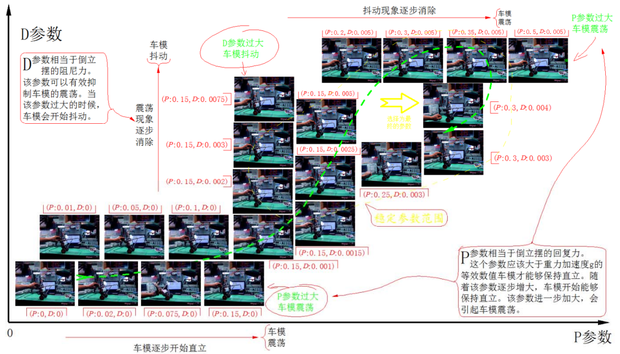
Map 6-21 Angle parameter adjustment process
